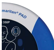
Abbildung 12. Keine Statusanzeige; Siehe Fehlerbehebung in Anhang B.
